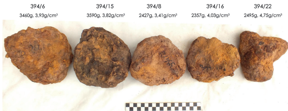
3. ábra: Az anyagvizsgálatra kiválasztott öt jakab-hegyi vasbucá tömeg és sűrűségadatokkal. Fotó: Thiele Ádám
